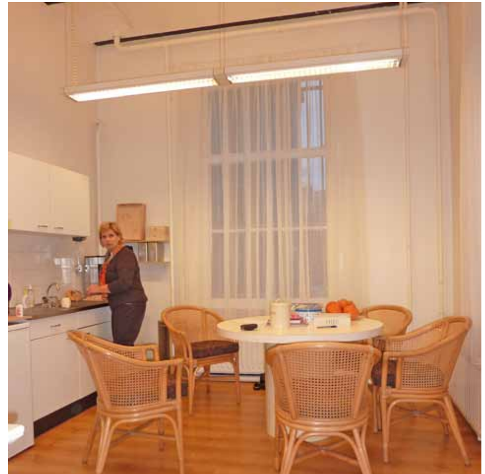
Afbeelding 27. Overzicht van de ruimte gezien richting het noorden. De schuifvensters in deze ruimte zijn niet voorzien van een lambrisering ter plaatse van de borstwering. Dit houdt verband met de oorspronkelijke functie van de ruimte als magazijn.
