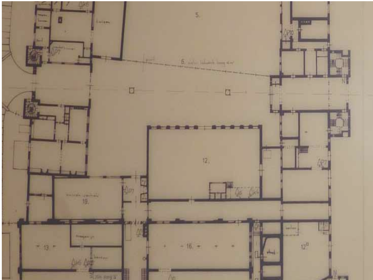
Afbeelding 26. Fragment van de revisietekening van de begane grond van bouwdeel K, tekening Rijksgebouwendienst 15-12-1976. Op de tekening is het complex afgebeeld juist vóór de ingrijpende verbouwing van 1988. Bouwdeel K zou daarbij gewijzigd worden, waarbij de bezoekersruimte en de toiletten in de hal zouden worden verwijderd. Collectie architectenbureau irs. Vegter.
